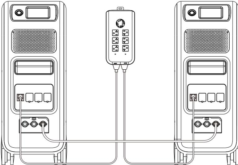
"Einphasig" (Single Phase) ist als Standardmaschinentyp festgelegt, wenn Sie einen einzelnen EP500 betreiben. Dies ist die korrekte Einstellung, wenn ein einzelner EP500 verwendet wird. Der „Device Typ“ wird benötigt, um den "Split-Phase" Modus zu aktivieren. Split-Phase wird zum Anschluss von zwei EP500-Einheiten (exklusiv für die 100-120V-Version) verwendet um die Ausgangsleistung, Spannung und Kapazität zu verdoppeln. Weitere Informationen finden Sie im Abschnitt Split-Phase-Einstellungen.
