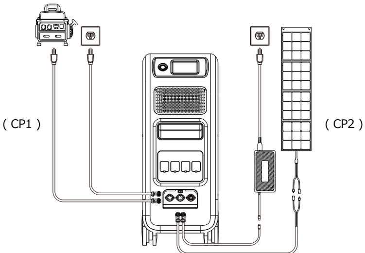
**Lademethode 5:** Der EP500 unterstützt das gleichzeitige Laden mit CP1 und CP2. Sie können alle zuvor aufgeführten Lademethoden gleichzeitig verwenden, um Ihre Ladeleistung zu maximieren. Sie sind hier noch einmal zur Übersicht aufgeführt. Wählen Sie eine Methode für CP1 und eine weitere Lademethode für CP2 für das gleichzeitige Laden.
